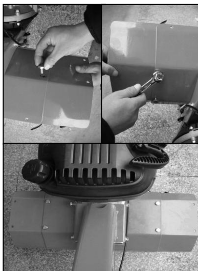
Montáž nožů a krytu kultivátoru
