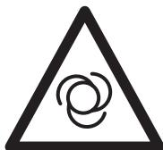
Uwaga! Urządzenie wyposażone jest w automatyczną kontrolę rozruchu. Osoby postronne powinny znajdować się z dala od pracującego urządzenia!
